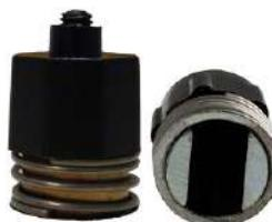
Les loqueteaux réglables sur tôle sont composés d'un circuit magnétique associé à un écrou et un ressort. Ces composants se fixent dans un trou rond percé dans la tôle ; ils donnent une légère mobilité, d'où un bon rattrapage de jeu. L'aimant peut être soit placé sous la tôle (l'aimant est alors complètement encastré), soit sur la tôle (il sert alors d'amortisseur). Existe en version chaleur : C 12-8 ch et le C 16-8 ch.
